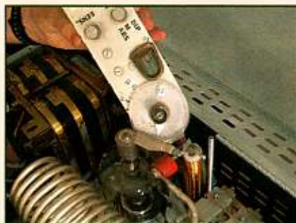
Het meten van de HF-choke met de griddipmeter.
